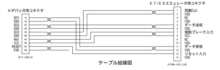
(注記) E7/E8エミュレータの説明ではターゲットとするMPUの信号名に合わせてコネクタの信号名をそのつど変えて表記しています。 信号名は変わっても基本的に信号の機能は同じものですので、本図では信号の機能を表す名称で表記しています。
