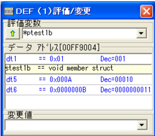
[1-6] ローカル構造体ポインタ配列変数「TEST1B *ptemp22[2][2]」の参照例 DEF Ver 7.70Bからの追加機能
