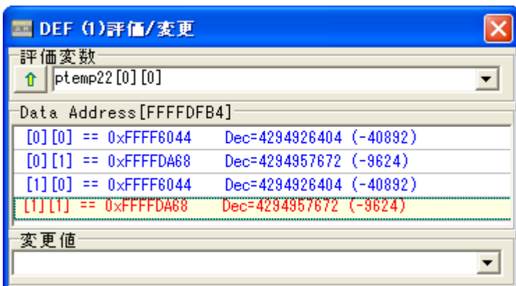
[1-6] ローカル構造体ポインタ配列変数「TEST1B *ptemp22[2][2]」の参照例 DEF Ver 7.70Bからの追加機能
