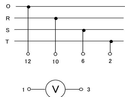
ジャンパー線(コモン線)に接続された端子ネジの締め付けはお客様にて締め付けトルクの再確認をお願いします。
