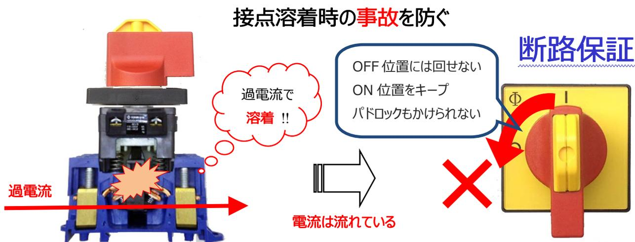
※1 通常操作トルクの 3 倍のトルクにて操作してもハンドルが OFF 位置にならないことを試験する。ただし、最小トルク 100N, 最大トルク 200N と規定。
